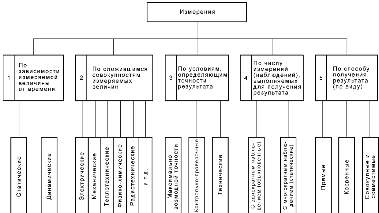
Рисунок 1 – Классификация средств измерения
